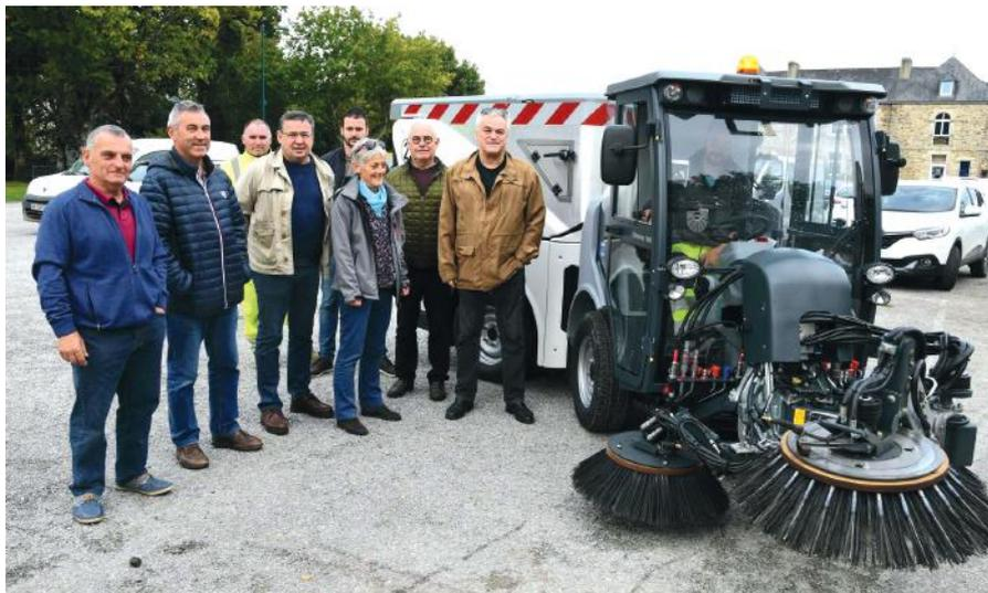
« balayeuse - nettoyeuse- désherbante ». Elle est équipée de balais rotatifs et dispose aussi d'un matériel de lavage haute pression qui permet de nettoyer le mobilier urbain , les panneaux de signalisation verticale et autres...).
